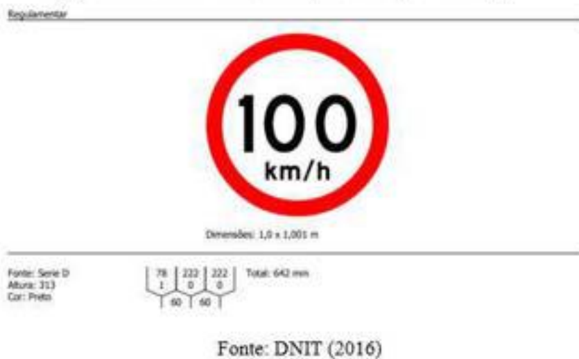
Figura 29 - Dimensionamento da placa R-19 (V= 100 km/h)
