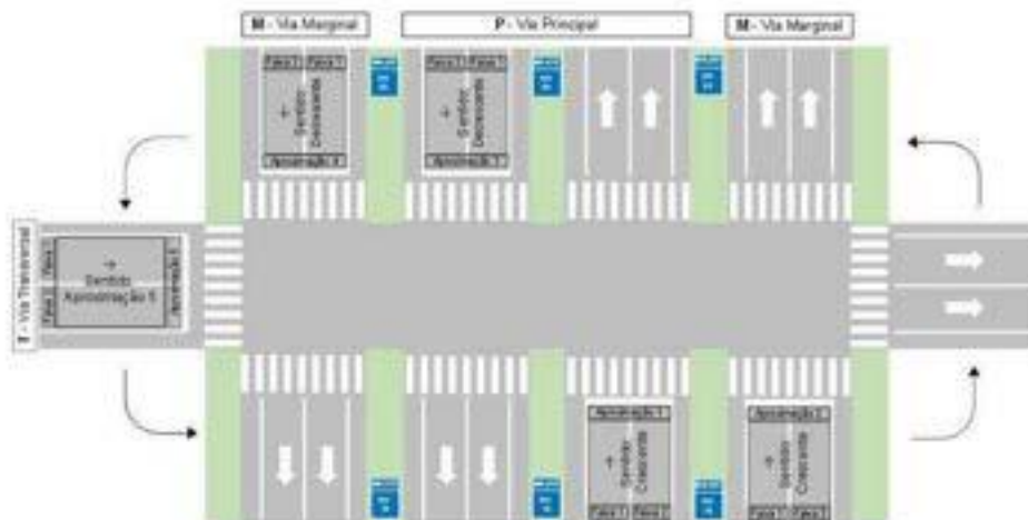
Figura 5: Rodovia duplicada, acrescida de pistas marginais, ocorrendo interseção em nível com 5 aproximações.
