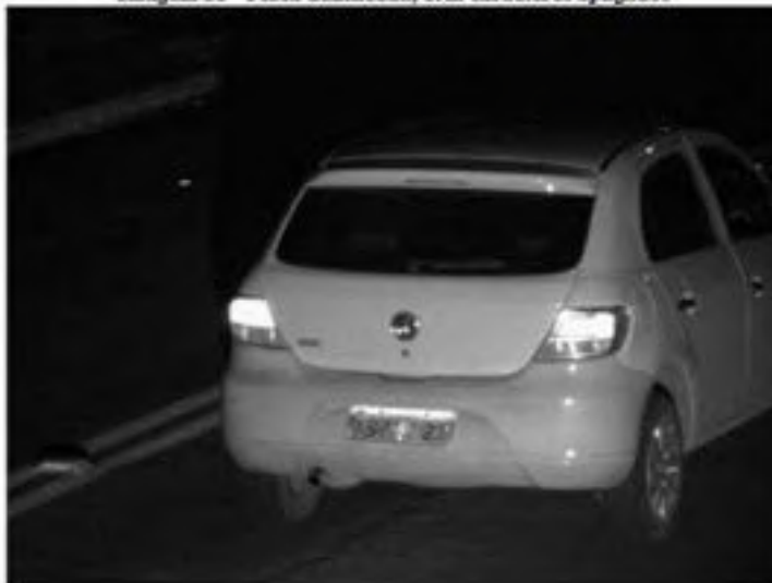
Imagem 21 - Placa danificada, com caracteres apagados
