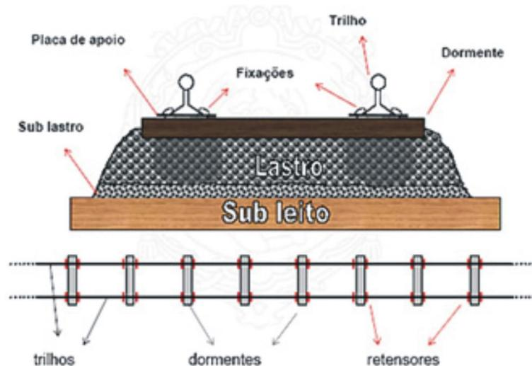
Sua característica elástica aumenta a vida útil do material rodante (locomotivas e vagões), da infraestrutura, dos trilhos e acessórios; além de distribuir os esforços na plataforma. Funciona como dreno o que aumenta (durabilidade) a vida útil dos dormentes, materiais metálicos e plataforma.
