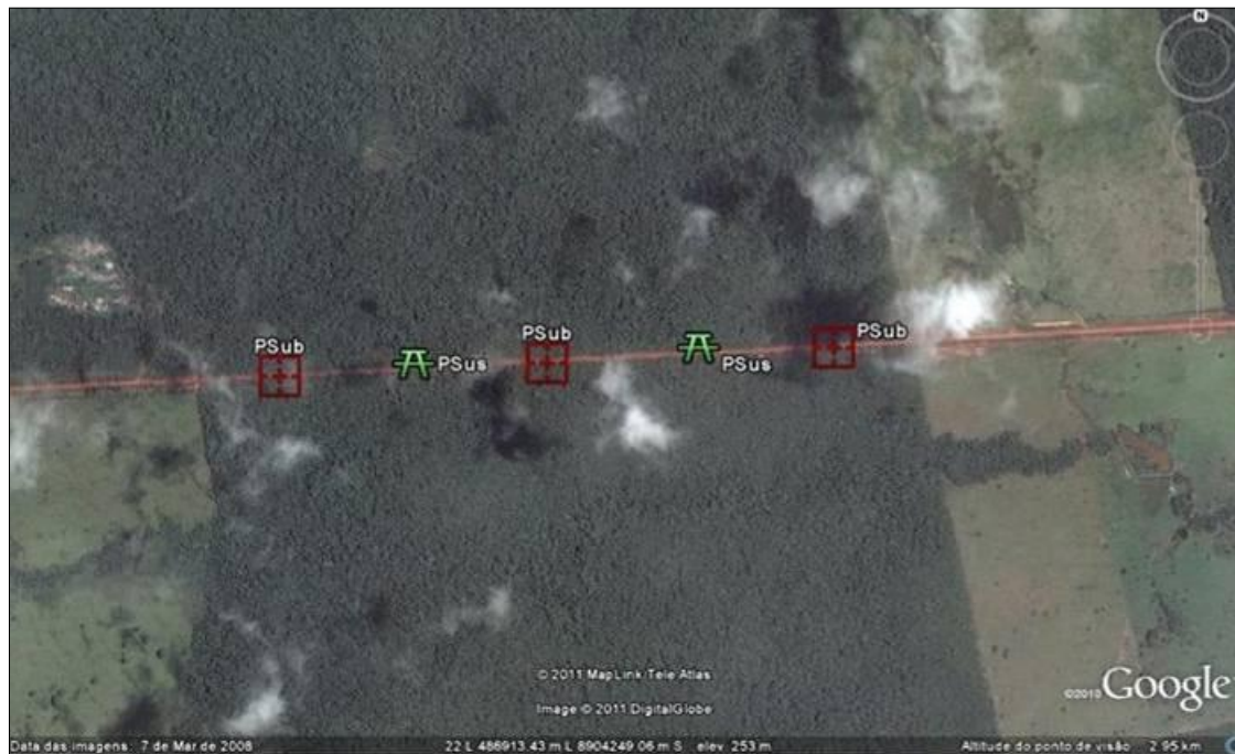
Figura 48 – Distribuição da localização dos dispositivos de proteção à fauna sugeridos para o fragmento de Floresta Ombrófila ao norte de Vila Rica, trecho da BR-158/MT. PSub: passagem subterrânea; PSus: passagem suspensa.
