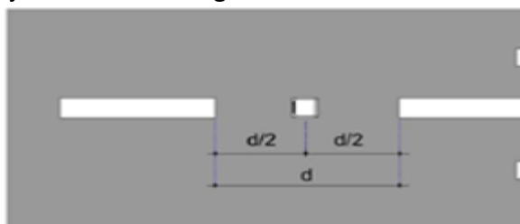
Figura 6: Posição da tacha junto à marca longitudinal seccionada amarela, no eixo da linha simples
