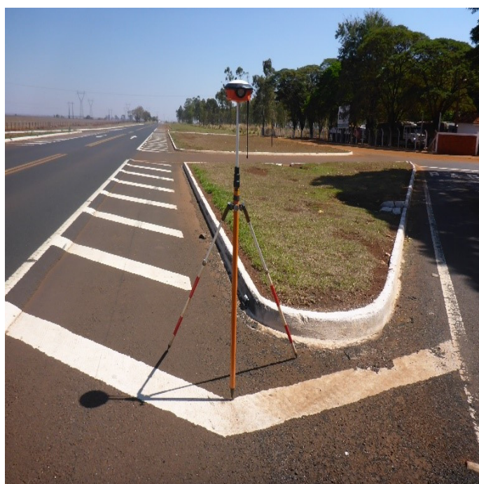
Figura 3: Ponto fotointersectável coletado em sinalização horizontal.
