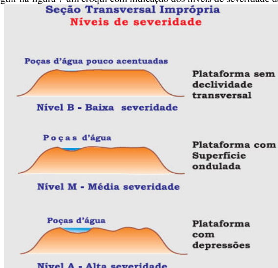
Figura 7 - Níveis de severidade da seção transversal imprópria. (Fonte: Baesso e Gonçalves, 2003)
