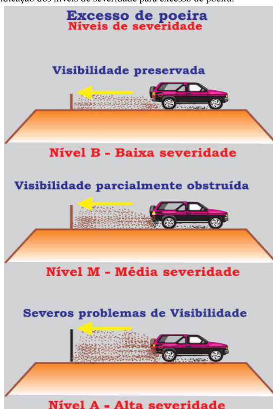
Figura 5 - Níveis de severidade para excesso de poeira. (Fonte: Baesso e Gonçalves, 2003)
