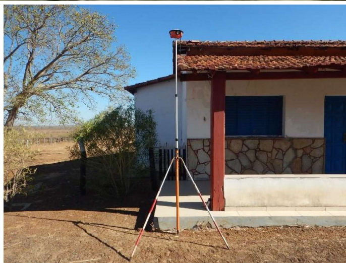
Figura 2: Ponto fotoidentificável coletado em quina de telhado.
