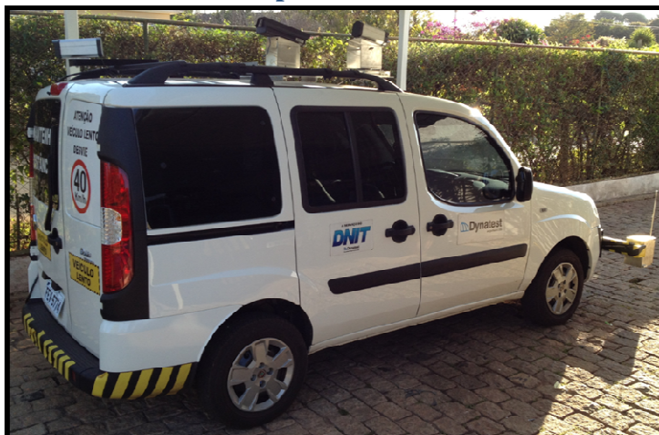
Figura 12 – Veículo Utilizado para o Levantamentos dos Dados do IRI
