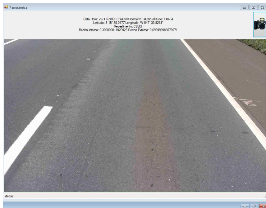
Figura 5 – Programa Utilizado para Realizar o Levantamento Visual Contínuo (LVC) - Câmera Fotográfica.
