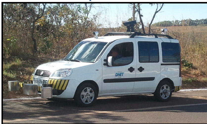
Figura 13 – Veículo Utilizado para o Levantamentos dos Dados do IRI
