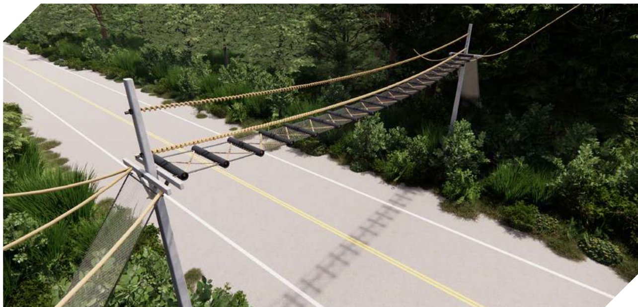
Figura 47. Desenho conceitual de ponte artificial de dossel demonstrando as camadas: inferior, intermediária e superior. © Projeto Reconnecta.
