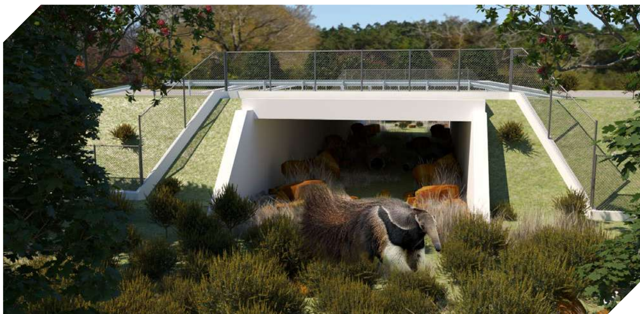
Figura 26. Desenho conceitual de passagem inferior de fauna do tipo BSCC (Bueiro Simples Celular de Concreto) associada ao cercamento. © ViaFAUNA.
