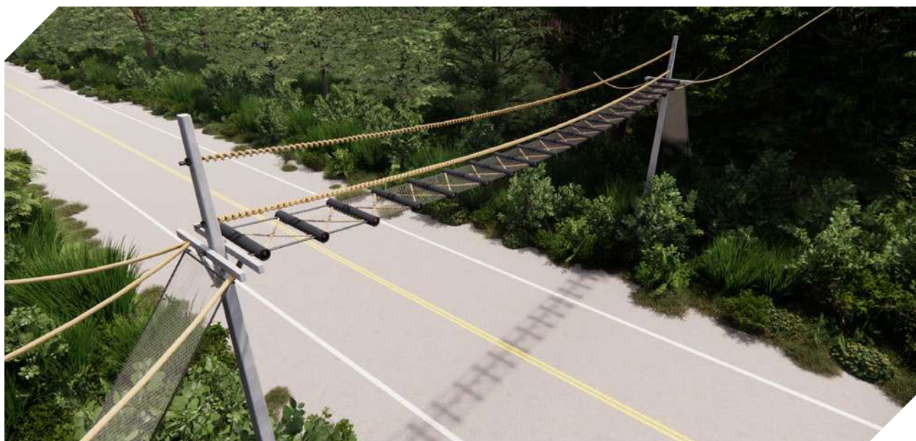
Figura 47. Desenho conceitual de ponte artificial de dossel demonstrando as camadas: inferior, intermediária e superior. © Projeto Reconecta.
