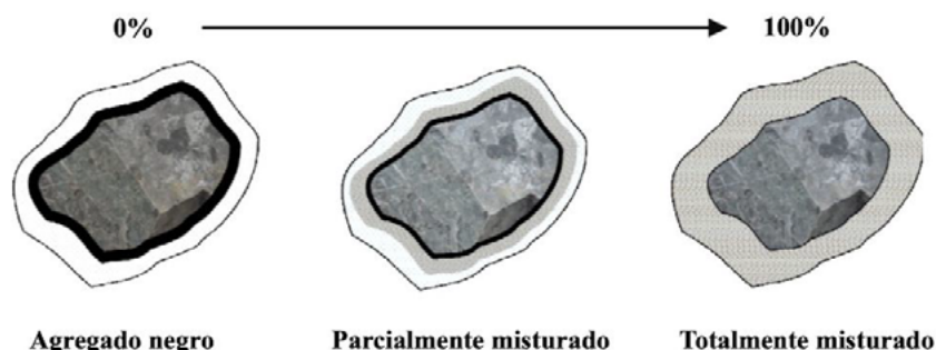
Figura 1 – Três cenários possíveis de misturas entre os ligantes asfálticos (novo e envelhecido)
