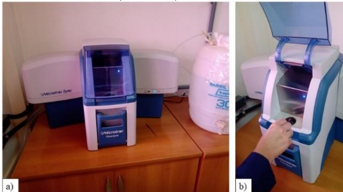
Figura 2 – a) Visão geral do equipamento analisador de partículas da Microtrac; b) Carregamento da amostra no equipamento para a análise das partículas de RAR
