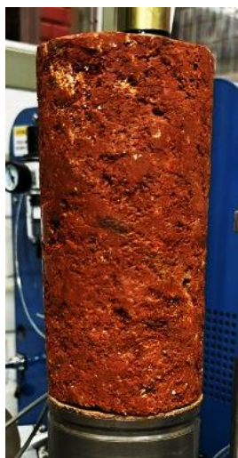
Figura 6 – Amostra CC esculpida para ensaio triaxial de cargas repetidas
