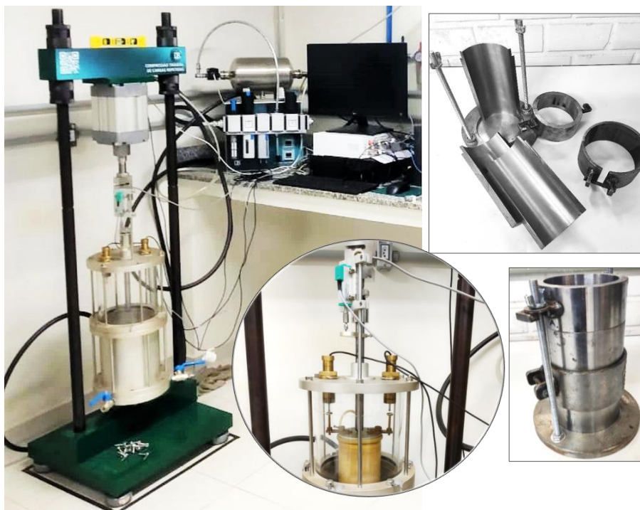
Figura 7 – Equipamento triaxial de cargas repetidas e molde tripartido
