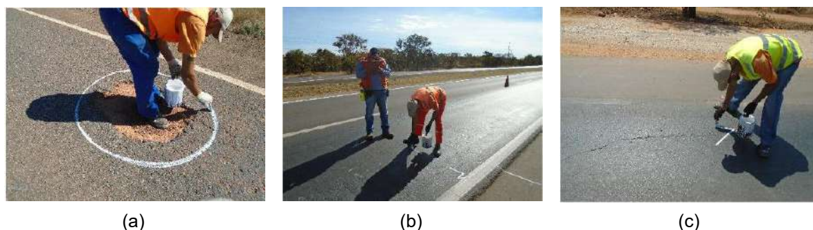
Figura 6 – Marcação dos defeitos existente nos pavimentos (DNIT, 2017)
