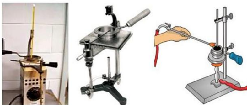
Figura 9 - Equipamentos utilizados para o ensaio do ponto de fulgor com a utilização do vaso aberto de Cleveland
