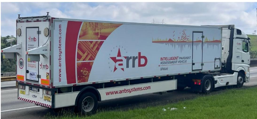
**Figura 1 – Veículo iPAVe da empresa AARB Systems realizando levantamento de rodovias federais para o DNIT**
