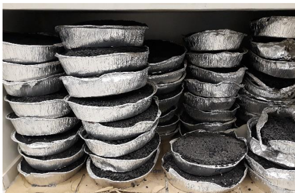
Figura 2 – Armazenamento de misturas asfálticas usinadas
