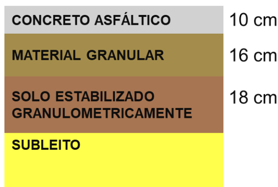
Figura 52 – Representação da estrutura existente
