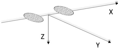
As coordenadas dos pontos em que são realizadas as análises devem estar ajustadas às posições dos sensores ou geofones do FWD. Isso deve ser realizado para permitir o cálculo dos deslocamentos de forma coerente. A Figura abaixo ilustra a posição dos sensores de um equipamento FWD.
