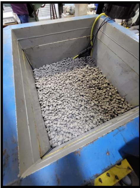
Figura 17: Detalhe de parte da camada de Lastro Instalada
