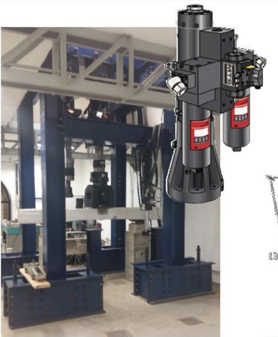
Figura 2 – Pórtico de reação e atuador servo-controlado.
