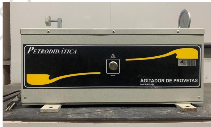
Figura A2 – Exemplo de agitador de proveta mecanizado.
