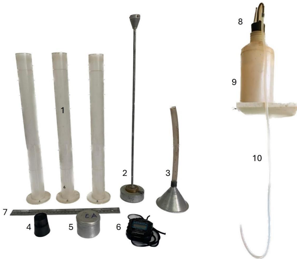
Figura A1 – Aparelhagem específica usada no ensaio de determinação de Equivalente de Areia. (1) Provetas graduadas. (2) conjunto de soquete de latão, disco perfurado e sapata, (3) funil, (4) tampa (rolha de borracha), (5) cápsula de alumínio, (6) cronômetro, (7) régua, (8) tubo lavador, (9) garrafão de 5 L e (10) tubo lavador.
