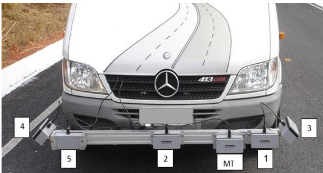
**Figura A2 – Barra com sensores para medida de irregularidade (1, 2, 5), sensores para medida de afundamento de trilha de roda (1, 2, 3, 4 e 5) e sensor para medida de macrotextura (MT)**
