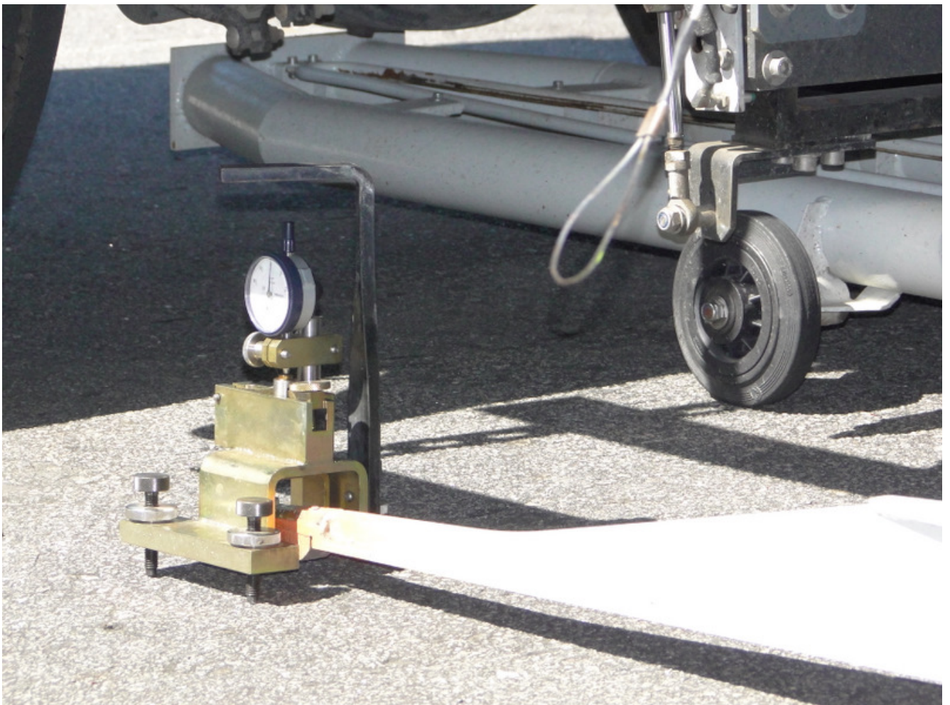
Foto 4 – Apoio da viga sobre o comparador
