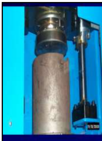
Molde e atuador de carga vertical
