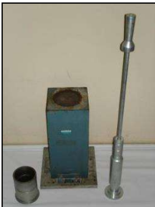
Molde montado, base de madeira e soquete manual
