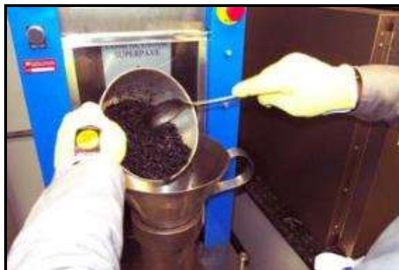
Colocação da massa no funil
