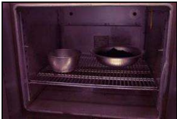
Aquecimento da massa asfáltica em estufa
