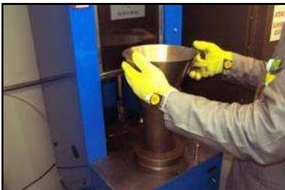
Colocação de funil no molde no compactador
