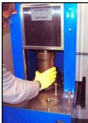
Molde sendo colocado no compactador
