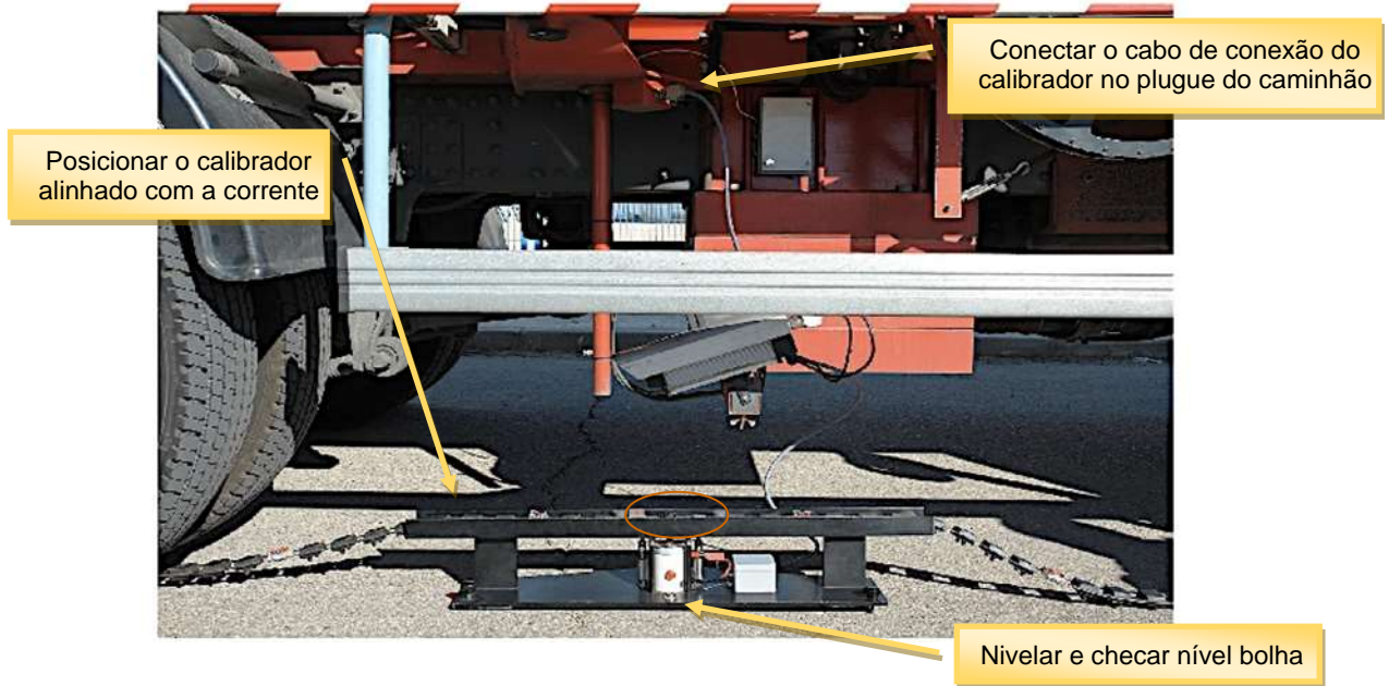
Foto 3 – Posicionamento do calibrador e conexão do cabo de dados
