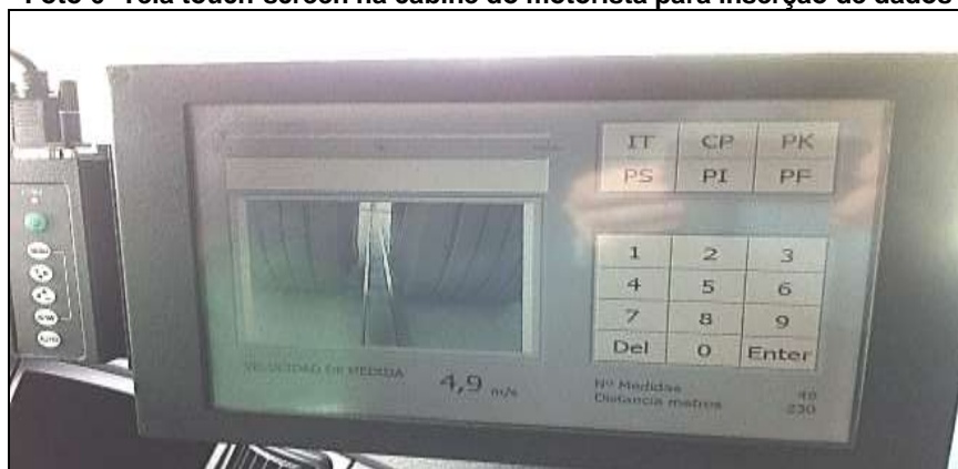
Foto 6 -Tela touch-screen na cabine do motorista para inserção de dados
