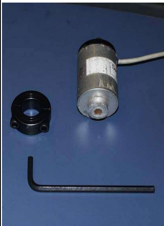
Foto 3- Acoplamento de um geofone KUAB no suporte de calibração
