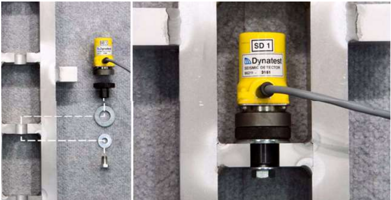
Foto 1- Acoplamento de um geofone Dynatest no suporte de calibração
