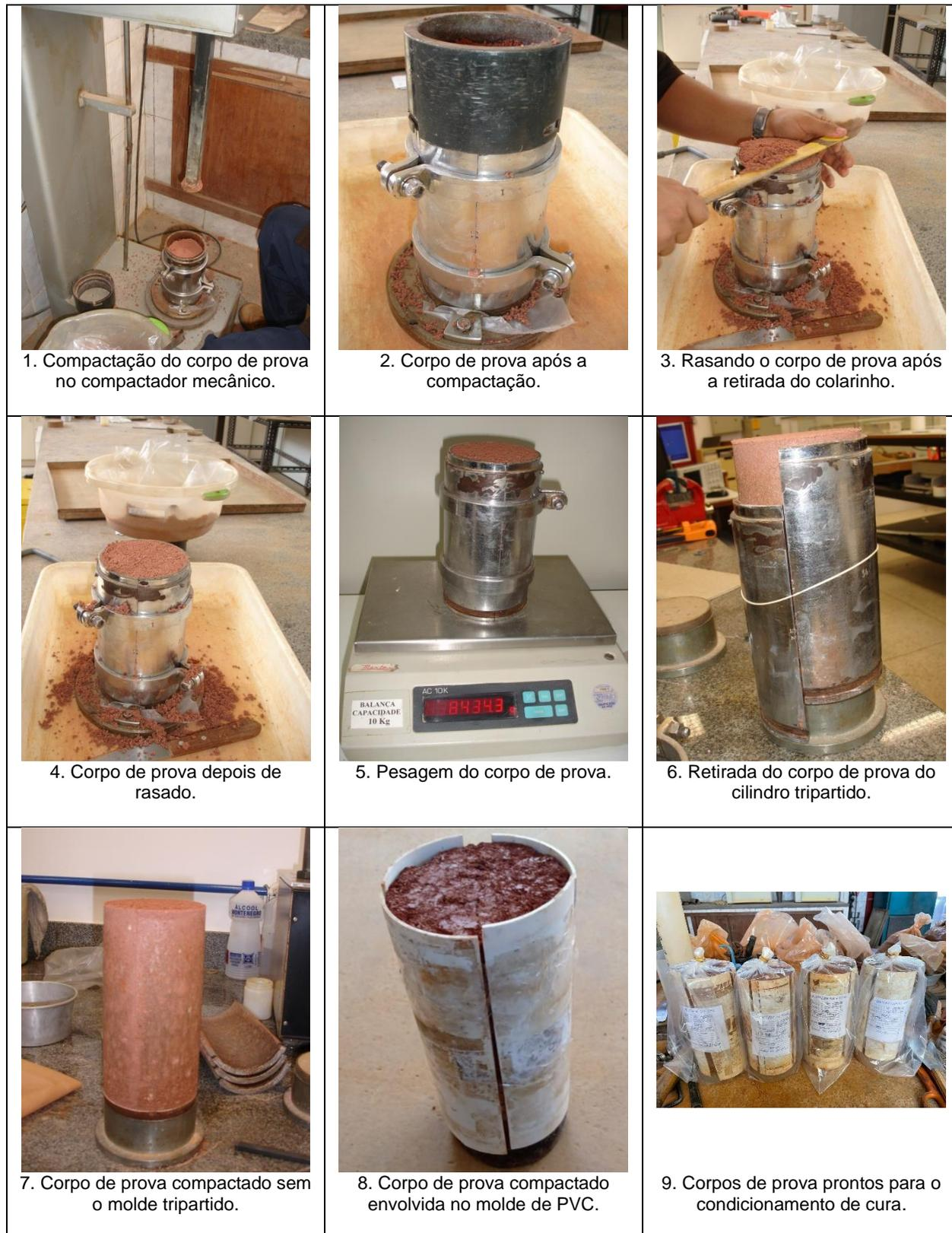
Figura C1 – Sequência de fotos desde a compactação do corpo de prova até o condicionamento para cura
