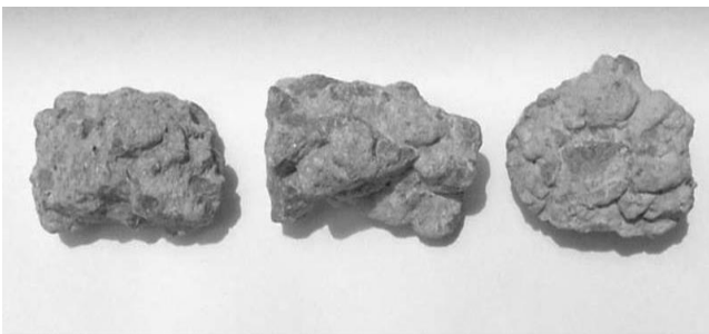
e) Partículas fraturadas (extremidades arredondadas, superfície rugosa)
