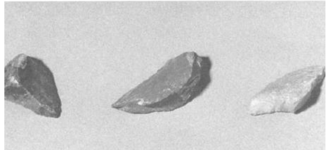
b) Partículas fraturadas (extremidades agudas, superfície lisa)
