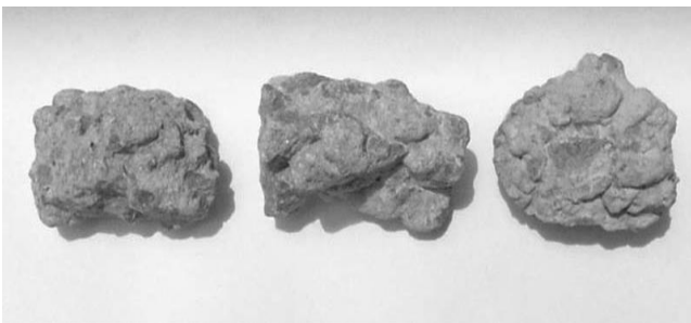
e) Partículas fraturadas (extremidades arredondadas, superfície rugosa)
