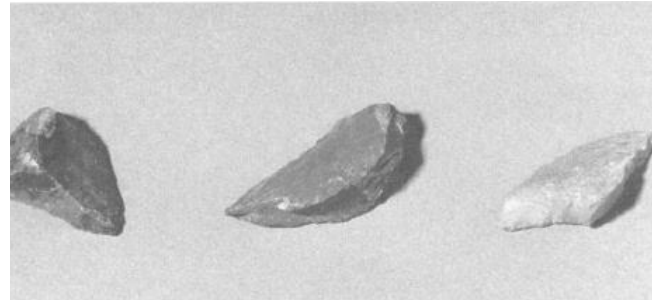
b) Partículas fraturadas (extremidades agudas, superfície lisa)
