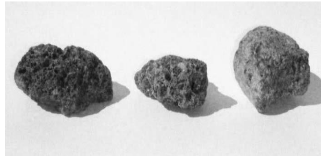
d) Partículas fraturadas (extremidades arredondadas, superfície rugosa)
