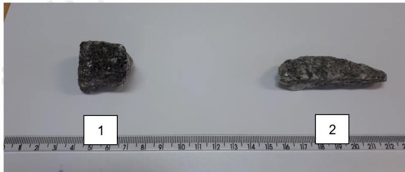
Figura A3 – Foto de dois agregados: Agregado (1) partícula não achatada e alongada e Agregado (2) partícula achatada e alongada.
