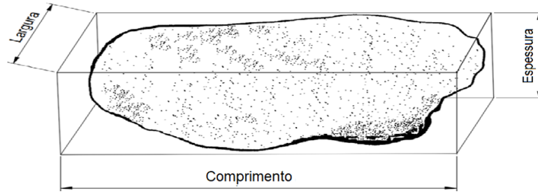
Figura A1 – Definição das dimensões de uma partícula de agregado graúdo.
