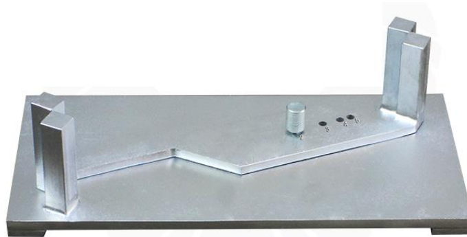
Figura A2 – Cálibre proporcional para medir partículas achatadas e alongadas.
