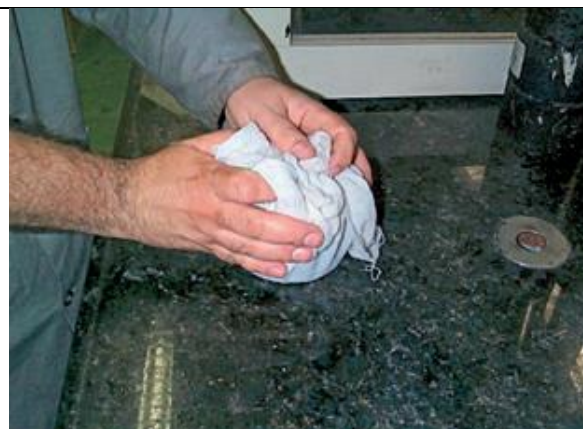
(g) Remoção da água na superfície do corpo de prova
