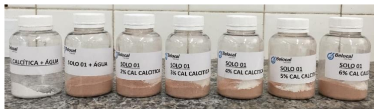
Figura 2: Potes com amostras de solo e cal para realização do ensaio do método do pH
