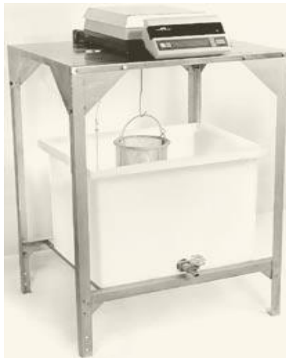
Figura B5 – Exemplo de conjunto de aparelhagem para este ensaio
