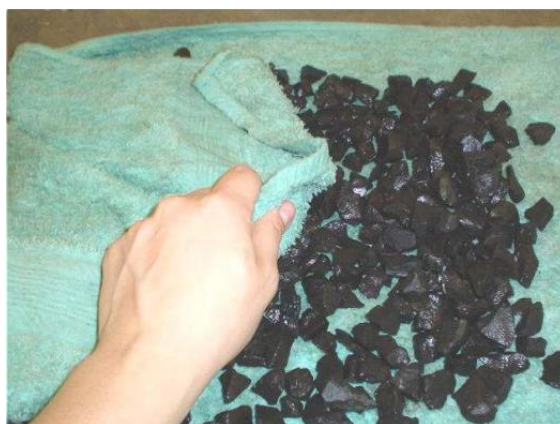
Figura B2 – Massa do agregado na condição Saturada Superfície Seca
