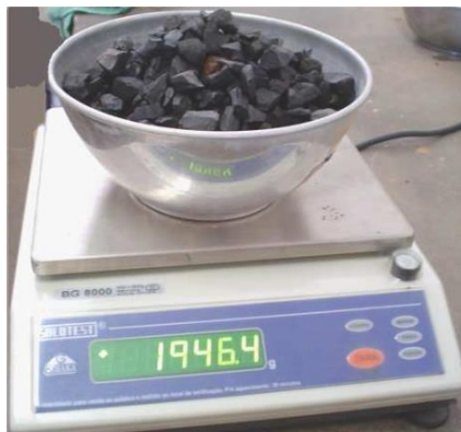
Figura B1 – Massa do agregado seco em estufa
