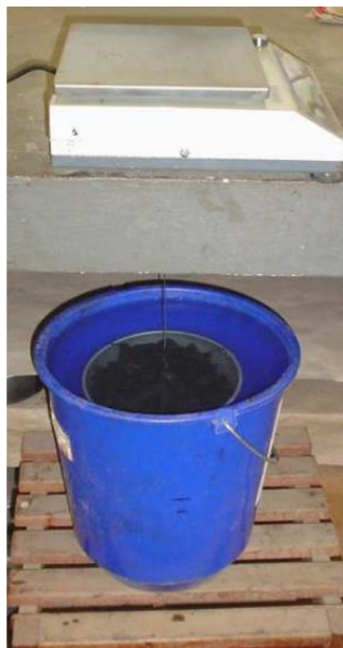
Figura B2 – Massa do agregado na condição Saturada Superfície Seca
