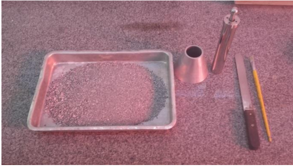
Figura A1 - Amostra de agregado seco em estufa com molde tronco cônico, soquete, pincel e espátula
