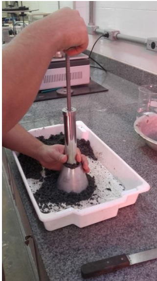
Figura A3 - Compactação do agregado dentro do molde de tronco cônico
