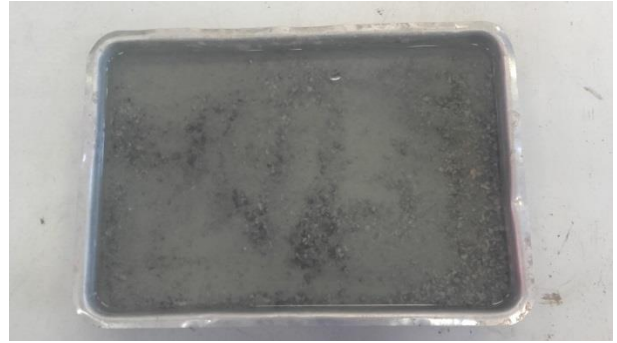
Figura A2 - Amostra de agregado saturado por 24 h
