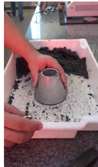
Figura A6 - Na posição para levantar o molde verticalmente
