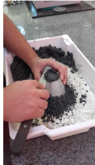
Figura A4 - Nivelamento do material com o topo do molde após a compactação
