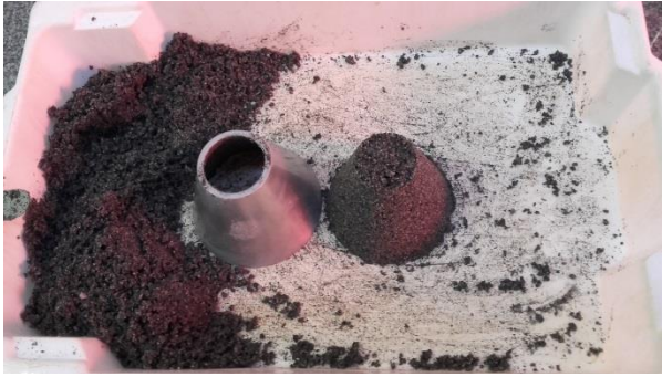
Figura A7 - Amostra de agregado com umidade superficial – amostra conservou a forma do molde
