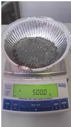
Figura A9 - Massa da amostra saturado superfície seca a ser colocada dentro do picnômetro
