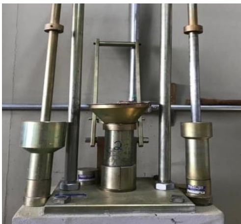
(a) Equipamentos e acessórios para o ensaio de compactação miniatura
