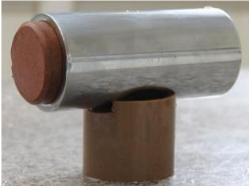
(c) Corpo de prova sobre o suporte para a imersão
