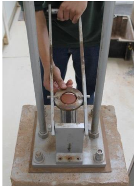
(a) Extrusão do corpo de prova compactado
