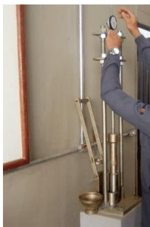
(e) Realização da leitura do extensômetro
