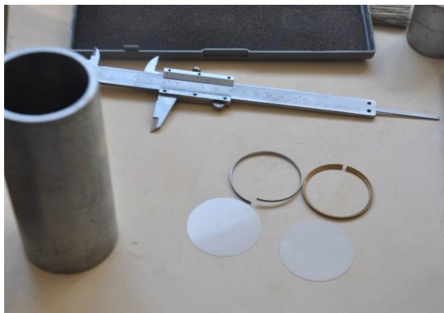
(b) Molde, discos de polietileno e anéis de vedação
