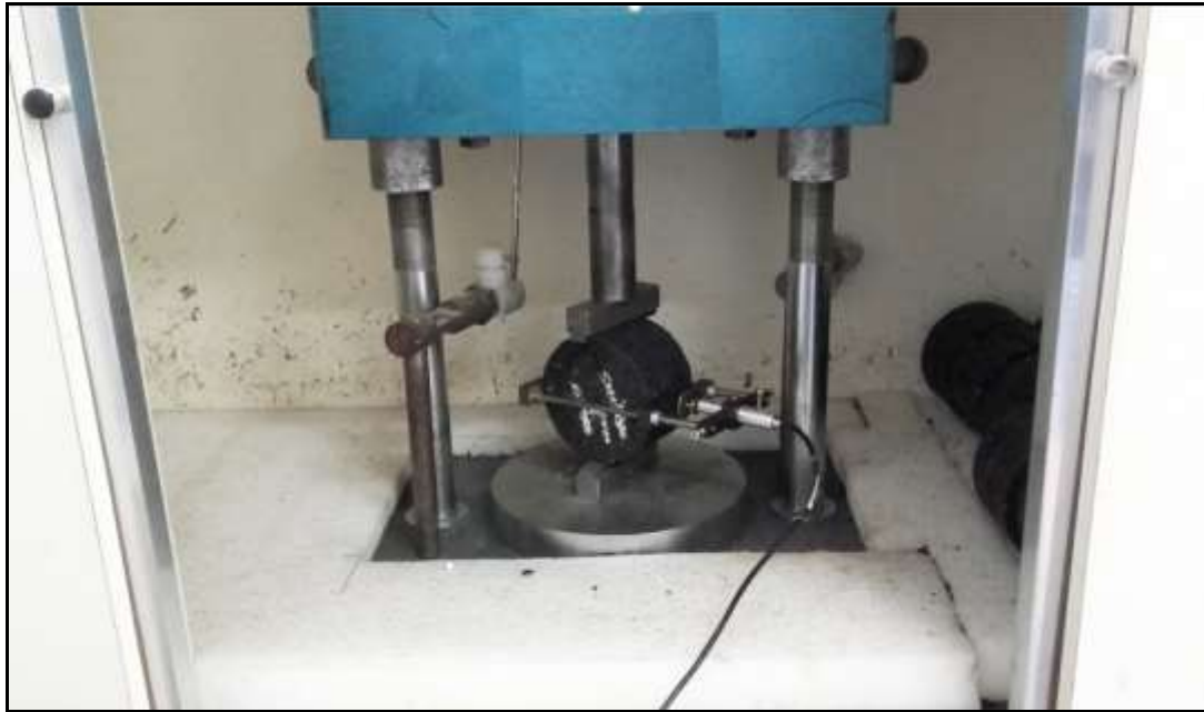
Figura 1 – Equipamento para previsão de fadiga, inicialmente realizado com LVDT externo preso ao corpo de prova por alça de referência
