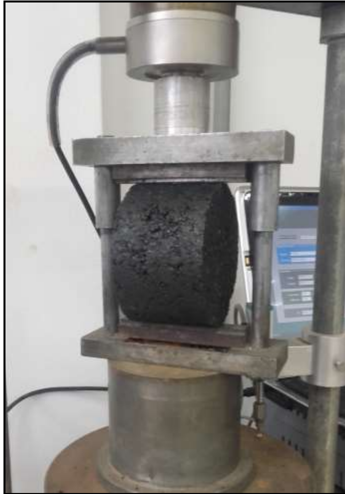
Dispositivo centralizador de posicionamento do corpo de prova
