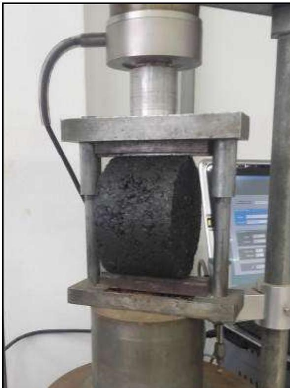
(a) – Dispositivo centralizador de corpo de prova.
