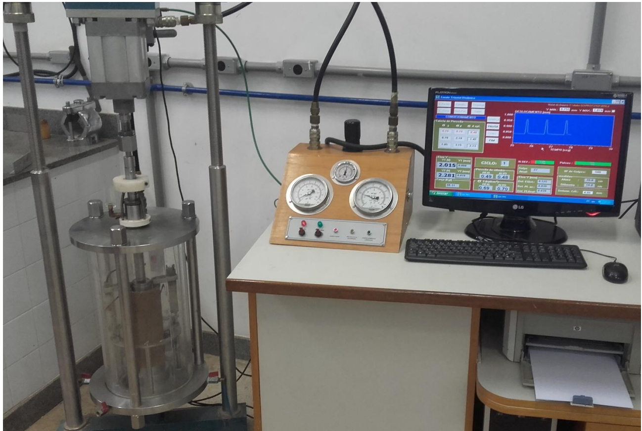
Foto - Exemplo de Equipamento triaxial com LVDTs fixados no cabeçote superior e apoiados em hastes guias.
