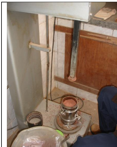
1 - Moldagem do corpo de prova (CP) compactador mecânico.
