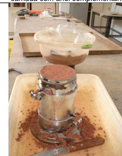
5 - Corpo de prova depois de rasado
