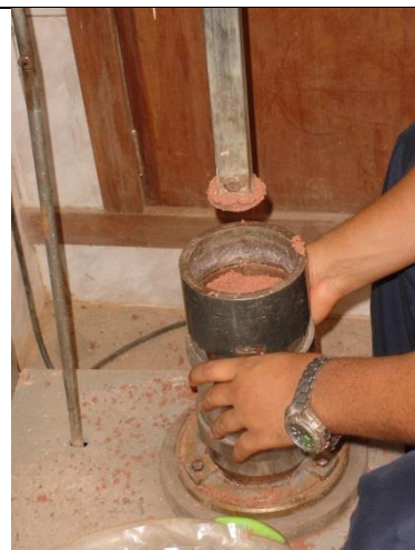
2 - Compactação da penúltima camada com anel complementar.
