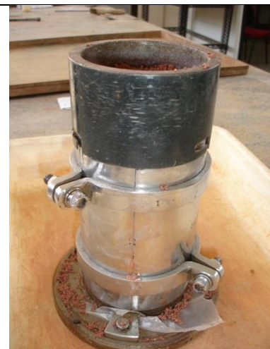
3 - Corpo de prova após a compactação da última camada
