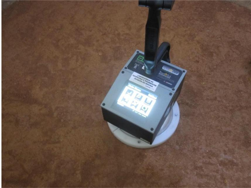
Figura 1 – Aparelho densímetro eletromagnético
