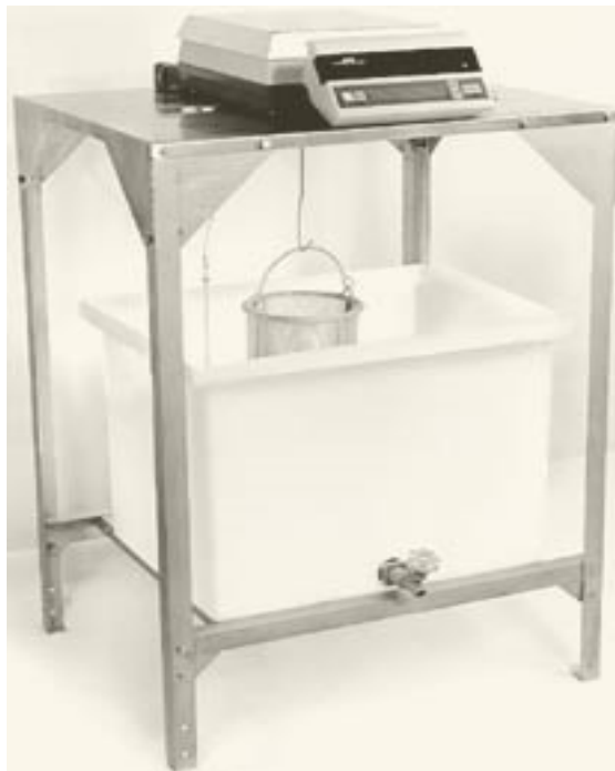
Figura C3 – Alguns passos do ensaio de massa específica do agregado graúdo
