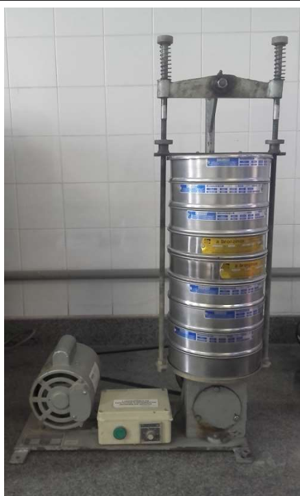
Peneirador com uma série de peneiras redondas
