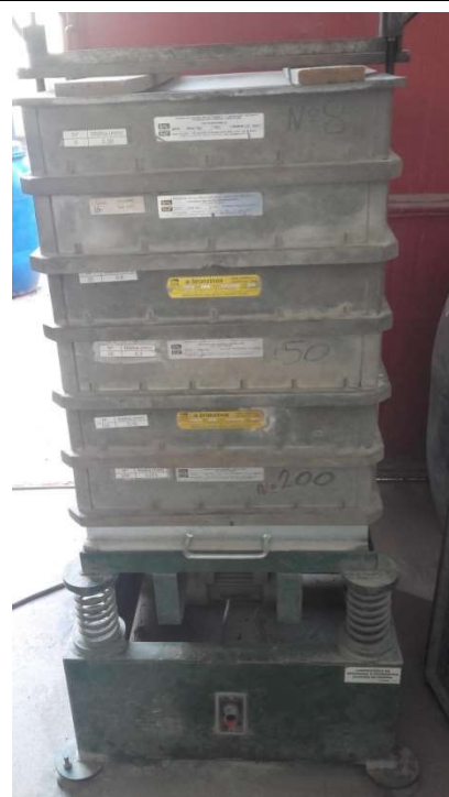
Peneirador com uma série de peneiras quadradas
