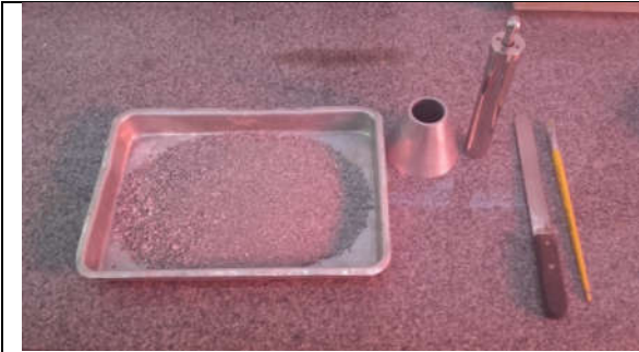
Amostra de agregado seca em estufa com molde tronco cônico, soquete, pincel e espátula.
