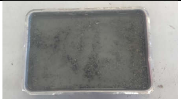
Amostra de agregado saturado por 24h
