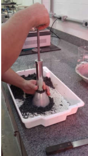
Compactação do agregado dentro do molde de tronco cônico
