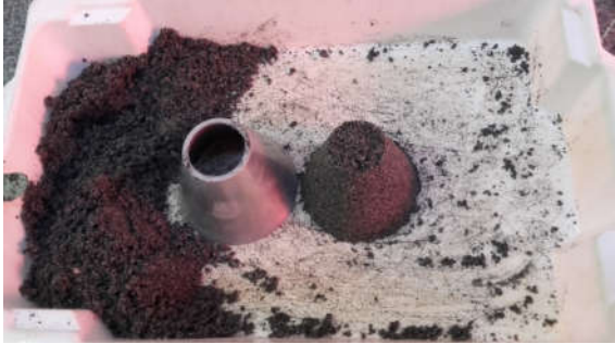
Amostra de agregado com umidade superficial – amostra conservou a forma do molde
