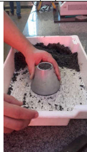
Na posição para levantar o molde verticalmente
