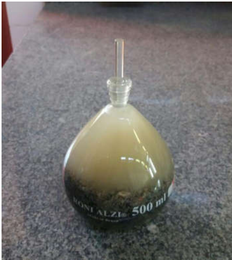
Picnômetro com amostra + água
