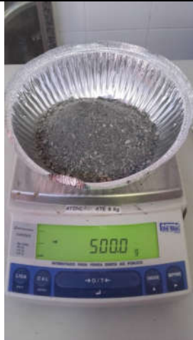
Massa da amostra saturada superfície seca a ser colocada dentro do picnômetro
