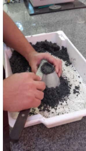
Nivelamento do material com o topo do molde após a compactação
