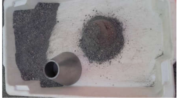
Amostra de agregado sem umidade superficial – cone desmoronou parcialmente ao retirar o molde (CONDIÇÃO DE UMIDADE DESEJADA)
