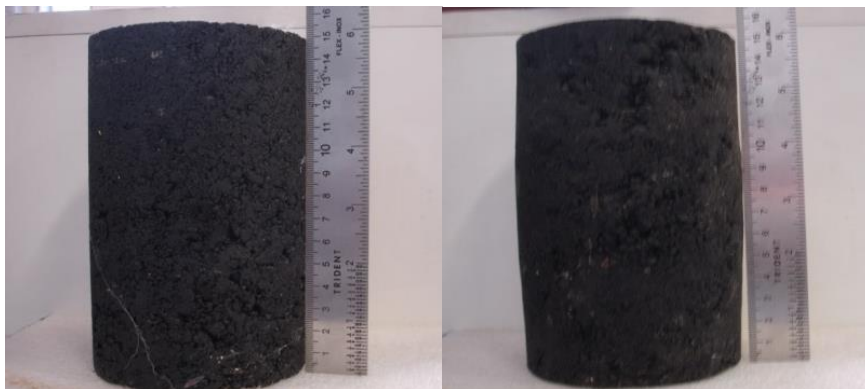
Foto 2 – Exemplo de um corpo de prova antes e após o ensaio de FN
