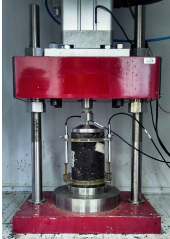
Foto 1 – Esquema de montagem do ensaio de número de fluência (FN)
