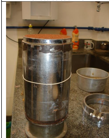
7 - Retirada do CP do cilindro tripartido
