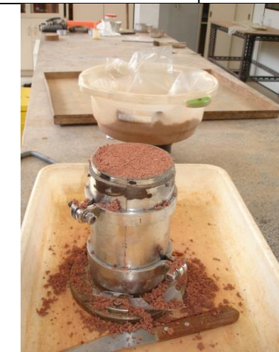
5 - Corpo de prova depois de rasado
