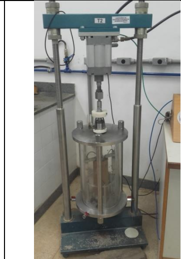
12 - Equipamento triaxial dinâmico pronto para ensaio.
