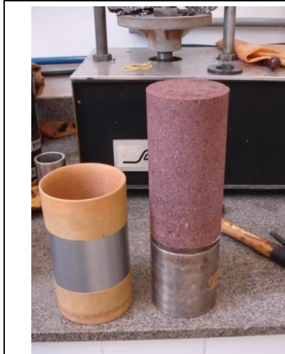
10 - CP desmoldado e encamisador com a membrana.
