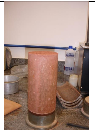
9 - Amostra moldada pronta para o ensaio (CP).
