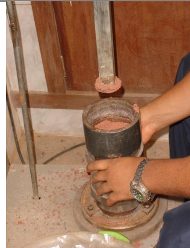
2 - Compactação da penúltima camada com anel complementar.
