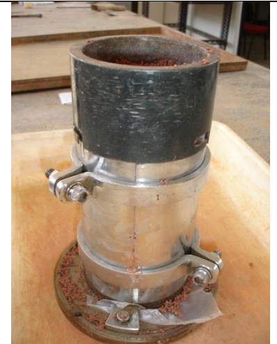
3 - Corpo de prova após a compactação da última camada
