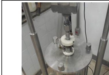
13 - Detalhe: Tampa colocada e fixada.
