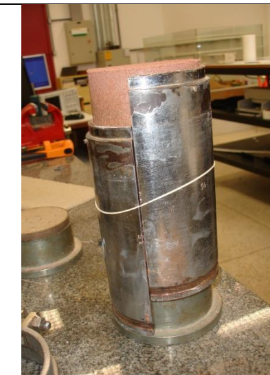
8 - Retirada do CP do cilindro tripartido.
