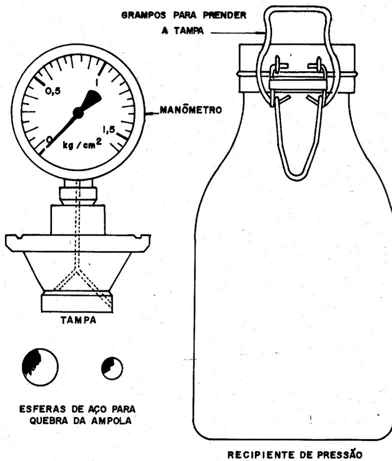
FIGURA - APARELHO "SPEEDY" PARA DETERMINAÇÃO DE UMIDADE
