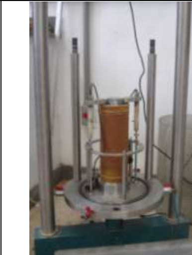
11 - Montagem dos LVDTs sobre o cabeçote na câmara triaxial
