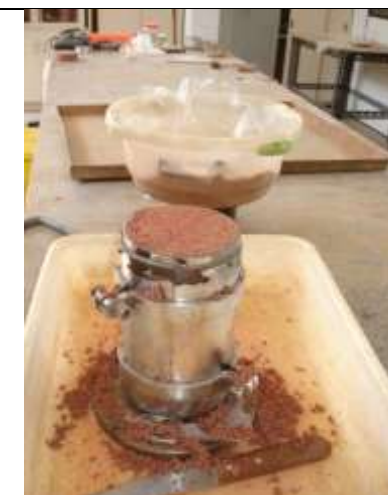
5 - Corpo de prova depois de rasado
