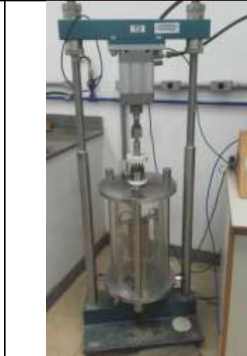
12 - Equipamento triaxial dinâmico pronto para ensaio.
