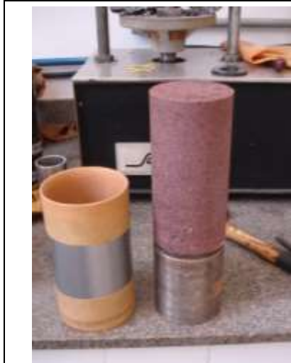
10 - CP desmoldado e encamisador com a membrana.
