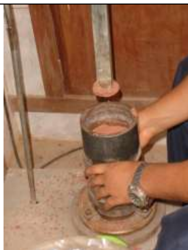
2 - Compactação da penúltima camada com anel complementar
