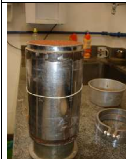
7 - Retirada do CP do cilindro tripartido
