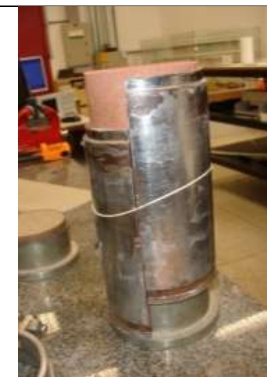
8 - Retirada do CP do cilindro tripartido
