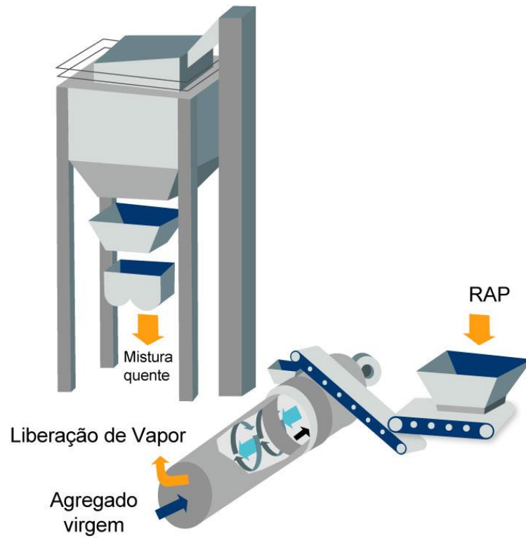
Figura B4 – RAP Frio em Usinas Gravimétricas – Adição de RAP em um anel de reciclagem
