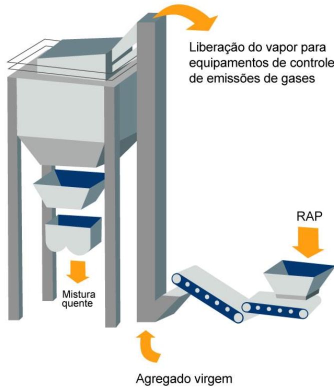
Figura B3 – RAP Frio em Usinas Gravimétricas – Método do elevador
