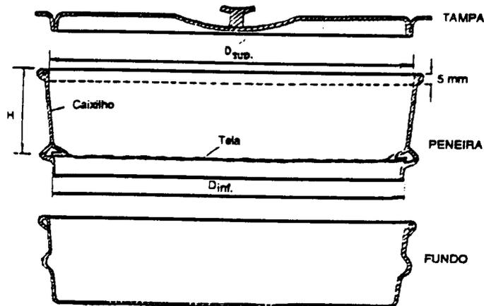
Figura 3 - Seção transversal da peneira com acessórios
