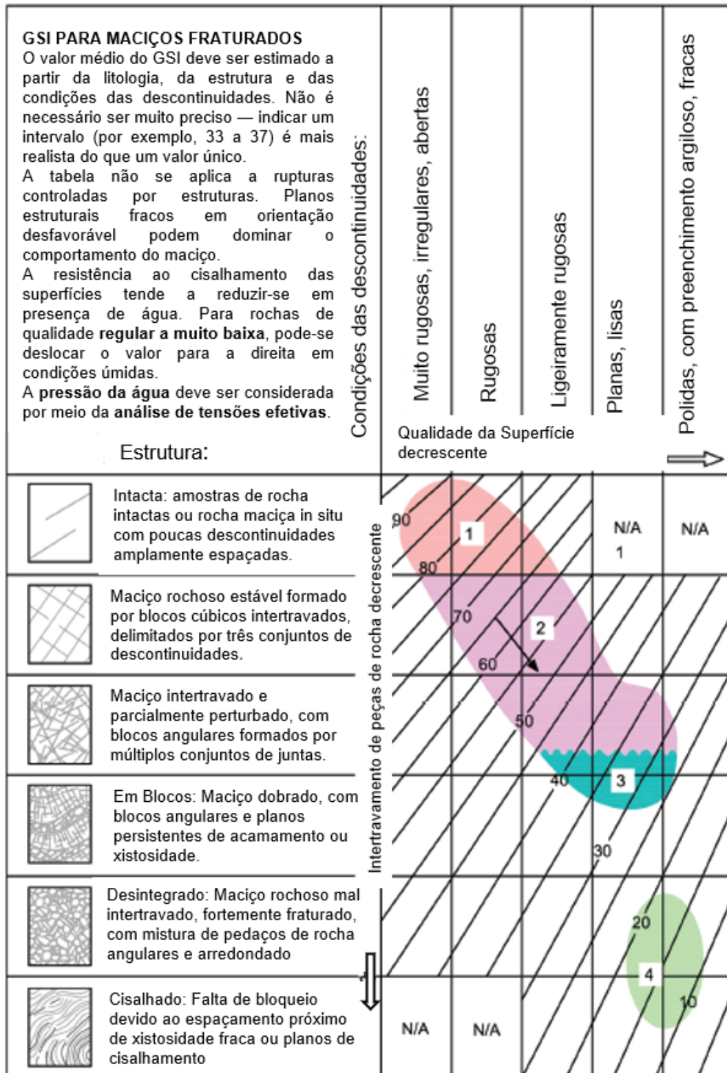
Figura 3.4 Índice de Resistência Geológica para rochas fraturadas
