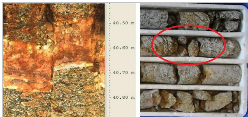
Figura AP.C2 Comparação entre falha detectada na imagem do OPTV, à esquerda, e região correspondente nos testemunhos de sondagem, onde ela passa imperceptível
