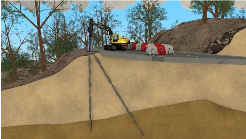
Figura 4.19 Estabilização por microestacas
